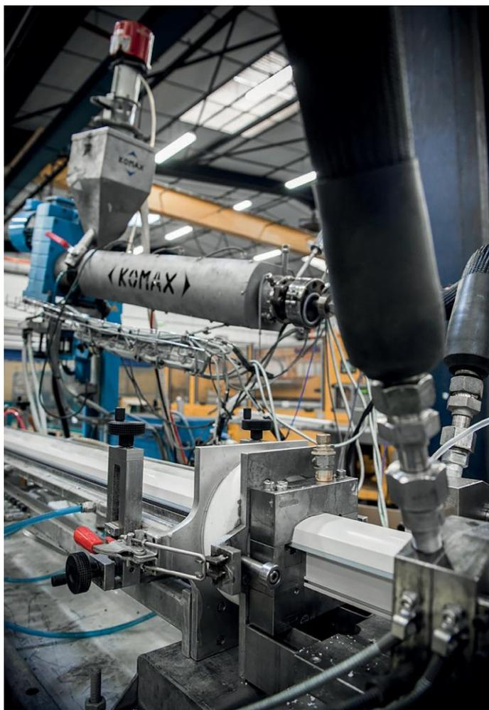
*Production de la nouvelle ligne VEKA REcycle qui intègre jusqu'à 70% de matière recyclée fin de vie.*
