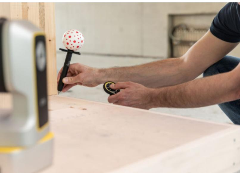
La station Leica iCON iCS50 intègre une caméra visuelle dopée à l'intelligence artificielle, capable de calculer en temps réel l'orientation, l'inclinaison, la hauteur et la position dans l'espace de la canne topographique Leica vPole. Cette technologie permet des implantations rapides et fiables, même dans des zones complexes, tout en réduisant les risques d'erreur.
