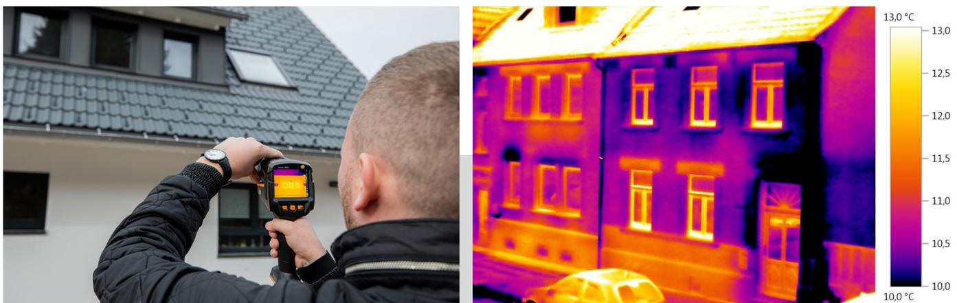
Afin de proposer aux bureaux d'études et conseillers en rénovation énergétique une caméra thermique leur permettant d'obtenir une meilleure vue d'ensemble des bâtiments sur lesquels ils recherchent des ponts thermiques ou des vices de construction, Testo enrichit sa gamme testo 883 avec une nouvelle caméra dotée d'un objectif grand angle : testo 883-2.
