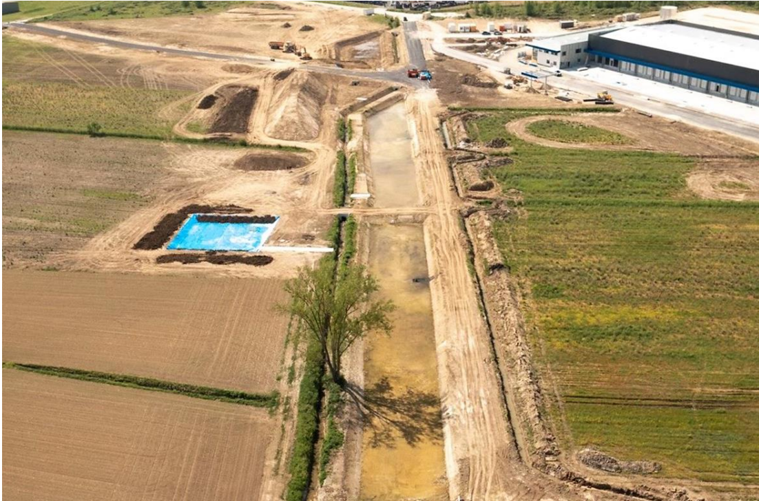
L'aquatextile GeoClean® (en bleu) a été placé dans le bassin de rétention à ciel ouvert de la ZAC Marmande Sud pour dépolluer les eaux pluviales lors de l'infiltration
