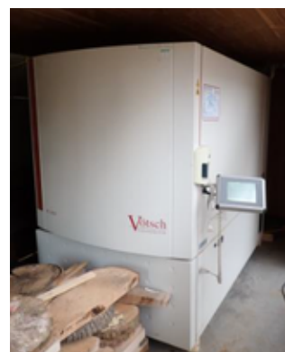
Enceinte climatique utilisée pour simuler le vieillissement de la gamme Wood'Ligne
