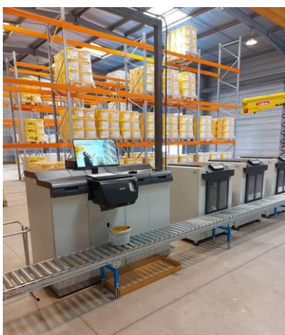
Nouvelle agence de Montpellier Ligne de teinte pour les enduits et peintures et zone de stockage de 700 m 2
