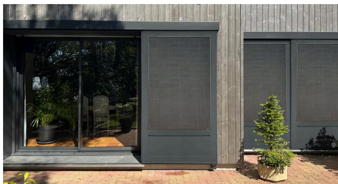
Techniquement, le Vol'Sun est constitué d'un cadre aluminium sur 4 cotés dans lequel est inséré un panneau solaire au format standard. Ces panneaux solaires ont une puissance avoisinant les 400 W. Les dimensions varient de 1 000 à 1 100 mm de large et de 1 500 à 2 000 mm de haut. Sa pose est facilitée au maximum, au moyen d'une simple prise électrique mâle à brancher sur une prise femelle de l'installation électrique du bâtiment.
