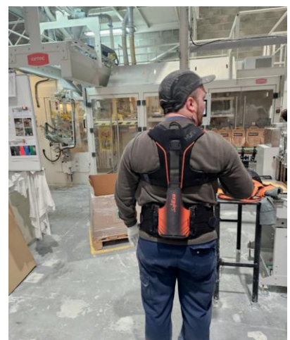
Les exosquelettes permettent aux collaborateurs Beissier de s'affranchir de la manipulation répétitive de charges lourdes.
