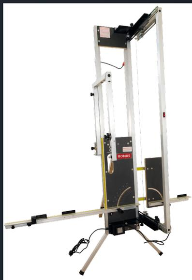
La table de découpe de polystyrène I.T.E permet de réaliser des coupes techniques au fil chauffant.
