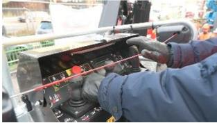
Un fil rouge est positionné au-dessus du poste de commande afin d'éviter tout risque d'écrasement de l'opérateur entre le poste de conduite et la charpente métallique sur laquelle il travaille. En cas de danger, si le corps vient appuyer sur le fil, le mouvement de la machine est bloqué automatiquement.
