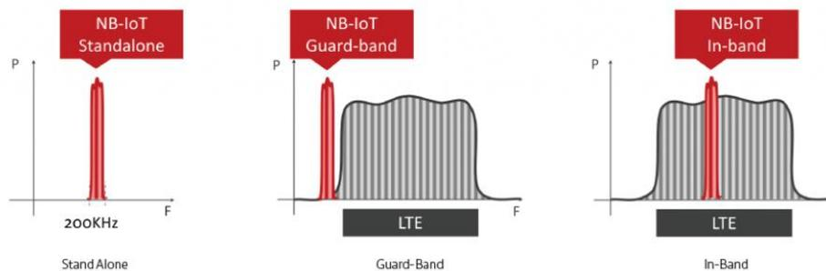
Figure 4 : Utilisation du spectre selon le mode de fonctionnement NB-IoT
