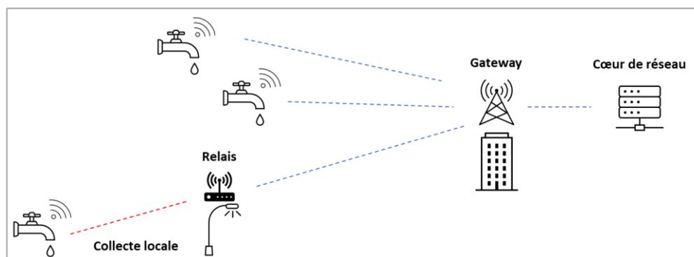
Figure 5: l'utilisation de relais permet une extension du réseau à coût réduit
