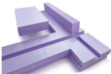
Le procédé d'isolation et de coffrage pour radier JACKODUR® Atlas consiste en un assemblage sur chantier de panneaux isolants thermiques en XPS pré-usinés en fonction du plan de fondation du projet de construction.
