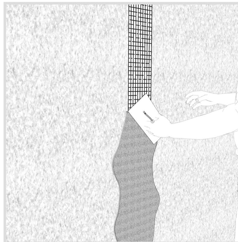
Des **jonctions également très faciles et rapides** à faire grâce au **kit d'étanchéité JACKOBOARD®** pour une réalisation **sans risque de ponts thermiques et sans risque de rupture de l'étanchéité**.
