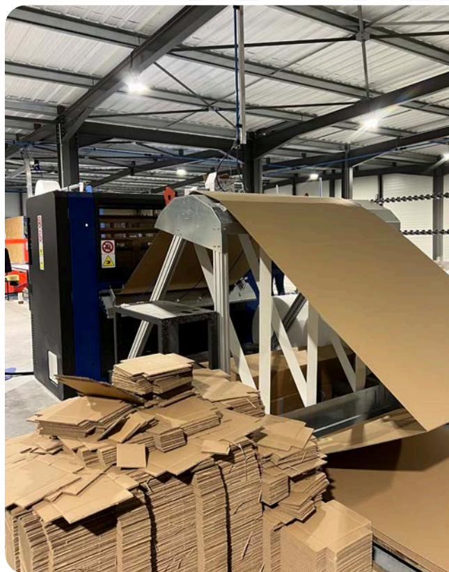
Nouvelle ligne d'emballage carton, découpe automatique au format des colis
