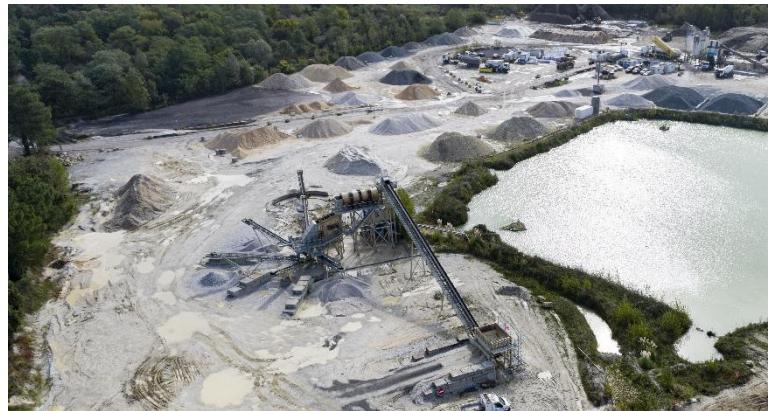
La plateforme EDYCEM de Mérignac traite et valorise les retours de béton de ses centrales du réseau bordelais, ainsi que les matériaux provenant de la déconstruction des bâtiments et de la voirie, et les déblais d'excavation.
