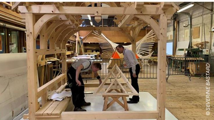
**LE METIER -** Le **charpentier** réalise les pièces des charpentes qui sont la structure de la toiture. À partir des plans fournis par l'architecte ou le dessinateur, le charpentier bois trace, en grandeur réelle, les formes de l'ouvrage avec les détails d'exécution. Il choisit le bois, trace les repères sur le matériau, coupe et façonne les pièces à l'aide de machines à commande numérique (scie mécanique, raboteuse, toupie verticale...) et d'outils portatifs.
