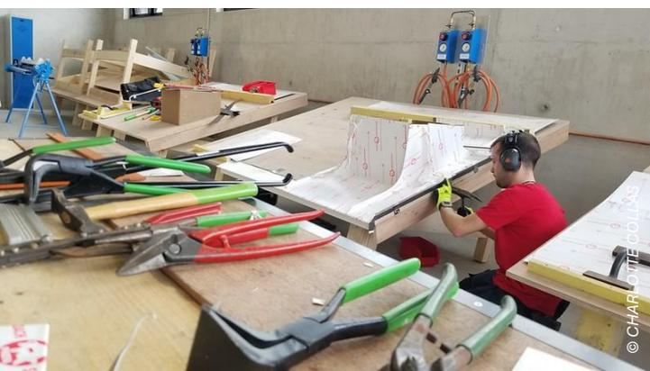
**LE METIER** - La **couverture métallique** met en œuvre des techniques modernes et traditionnelles pour couvrir un bâtiment. Les couvreurs métalliques étudient d'abord des plans et le cahier des charges pour déterminer le type et la quantité de matériaux dont ils auront besoin. Ils mesurent alors, coupent, plient, forment et fixent les pièces pour assurer l'étanchéité du bâtiment, des contresommets et d'autres produits personnalisés.
