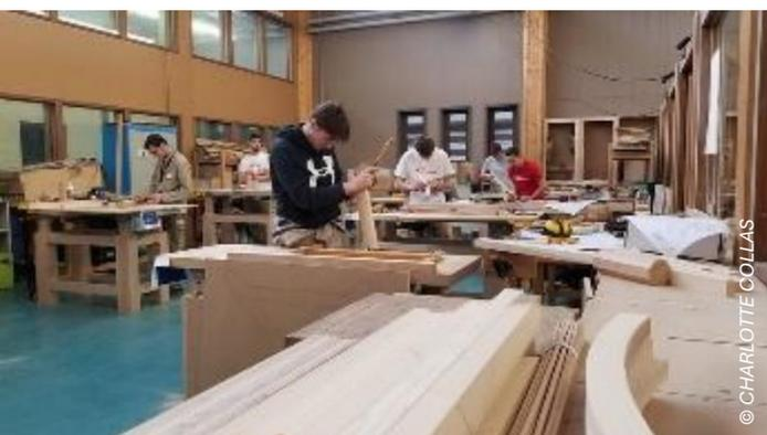
**LE METIER** - La **menuiserie** consiste à connecter et joindre plusieurs pièces grâce à divers assemblages. Le menuisier travaille des matériaux tels que le bois, l'aluminium et le PVC. Ce professionnel du bâtiment fabrique sur mesure et assemble des éléments : portes, volets, fenêtres, placards...
