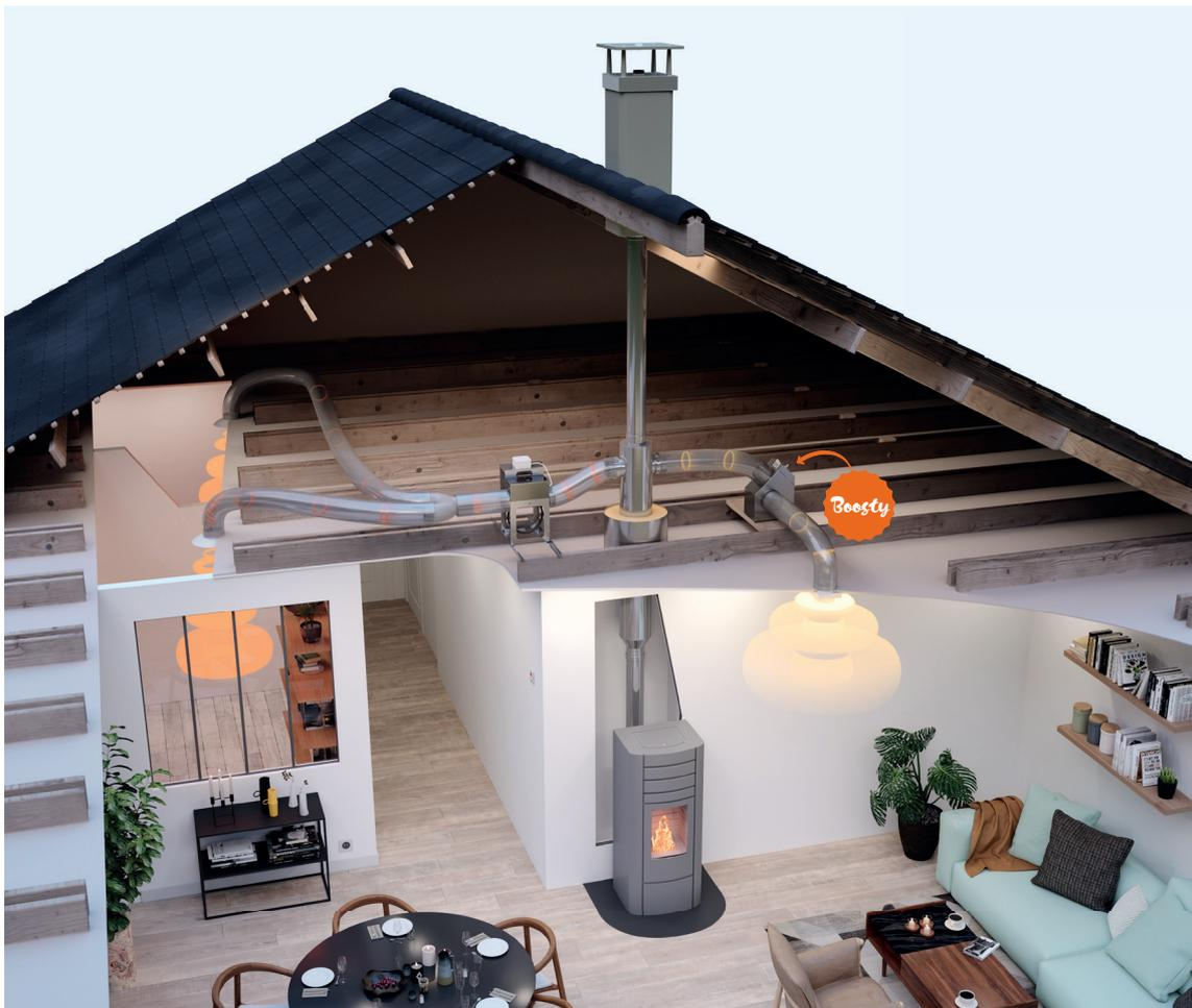
Le système AIRWOOD récupère l'air ambiant de la pièce de vie, puis réchauffe cet air dans le conduit échangeur et le redistribue dans toute la maison de façon homogène et efficace, par des bouches de soufflage. Lorsque l'appareil de chauffage au bois n'est plus alimenté, BOOSTY prend le relais.
