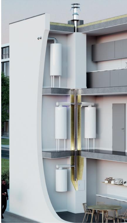
Depuis 4 ans sur le marché et précurseur en son temps, le **système collectif concentrique 3CE THERMO-D** mis au point par Cheminées Poujoulat, qui permet l'**amenée et l'évacuation d'air des chauffe-eaux thermodynamiques qui y sont raccordés dans les immeubles**, évolue.
