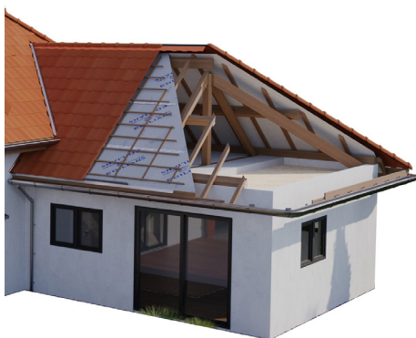
Isolation des combles perdus
