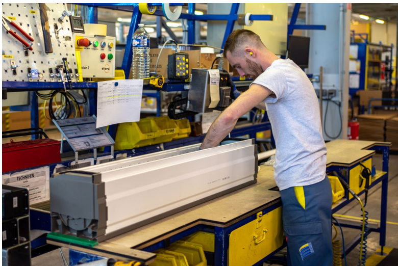
Un technicien assemblant un volet roulant PVC sur une chaîne de production ©Soprofen
