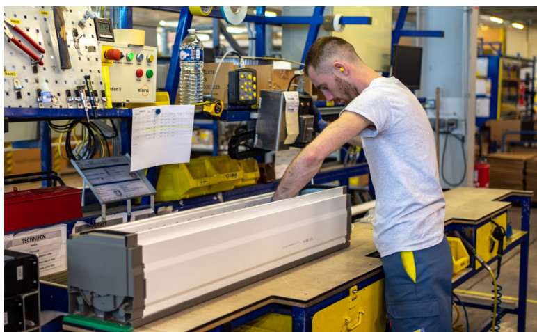
Un technicien assemblant un volet roulant PVC sur une chaîne de production ©Soprofen
