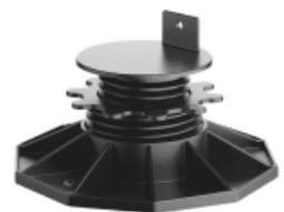
La gamme de plots terrasse réglables ECONOMIQUE est idéale pour mettre à niveau des surfaces inclinées et pour égaliser des différences de hauteur. Comportant un clip intégré sur la tête, ces plots permettent une fixation rapide de lambourdes en bois et en aluminium à l'aide de vis.
