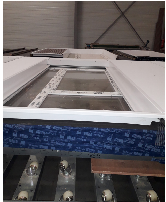
© Lorillard Ajustement de la menuiserie dans les ateliers de BuildUp
