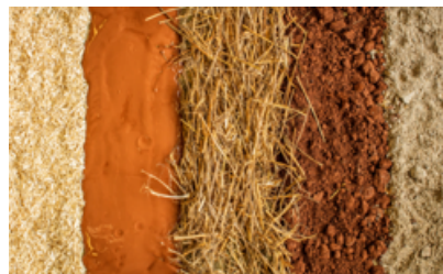
Photo : De la terre à la fibre, composants naturels du procédé CobBauge @Plymouth University
