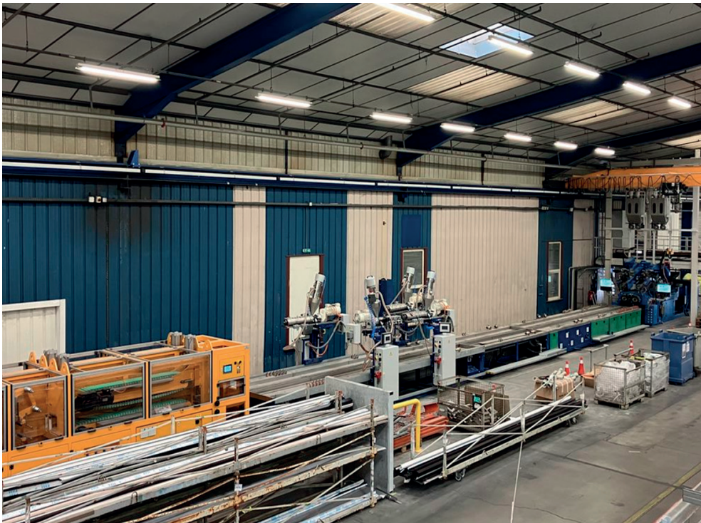
Nouvelle ligne de co-extrusion VEKA permettant l'intégration de matière recyclée au cœur des profilés PVC
