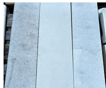
Échantillons de chaperons mis en vieillissement pendant 12 mois À gauche et à droite : Optipose® classique Au centre : Optipose® Slim
