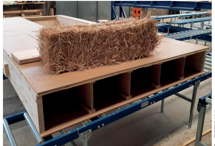
Ci-dessus, vue de fabrication du caisson avec remplissage paille.
