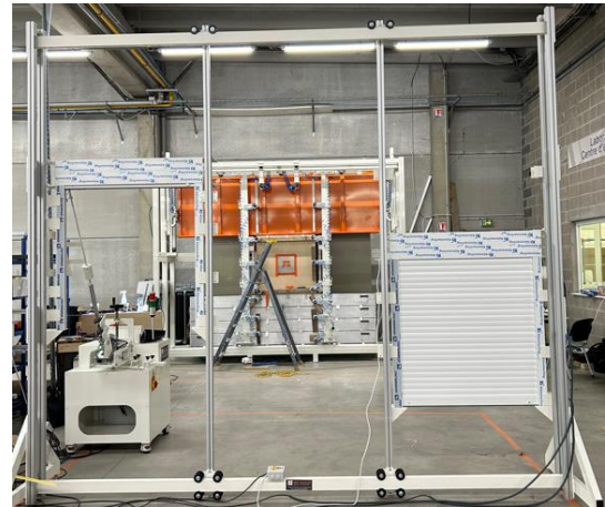
©Ouvéo Hauts-de-France – 2 Nouveaux Centres d'essai - Gauche pour Châssis PVC – Droite – Pour châssis Volets Roulants
