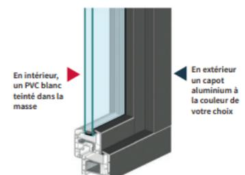
**En intérieur et extérieur** – Un profilé PVC blanc teinté dans la masse fabriqué à partir des Profilés PVC Kömmerling Greenline® sans plomb (remplacé par une formulation calcium-zinc aux propriétés identiques).
