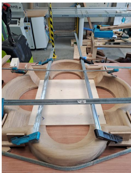
Visuel 9 : Un des huit quadrilobes du fût en cours d'assemblage. © Rebâtir Notre-Dame de Paris.
