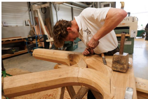
Visuel 6 : Finition des moulures au ciseau à bois et à la gouge par un apprenti. © Patrick Zachmann – Magnum Photos
