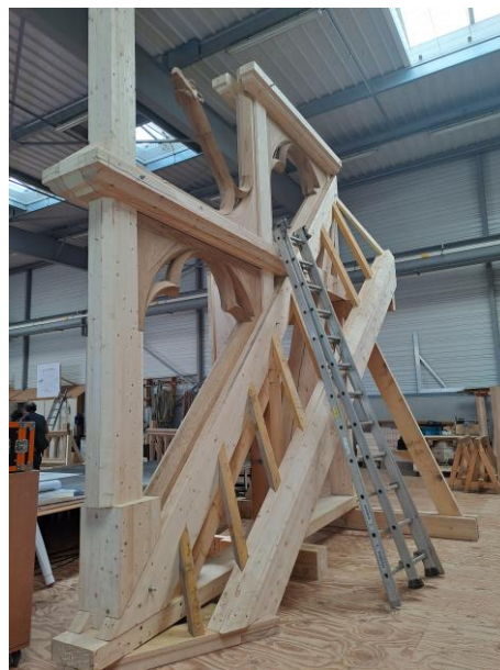
Visuel 2 : Prototype d'un demi-gradin orné de deux panneaux de décor. Chaque gradin supportera quatre des seize statues restaurées de la flèche et comportera trois panneaux de décor. © Rebâtir Notre-Dame de Paris.
