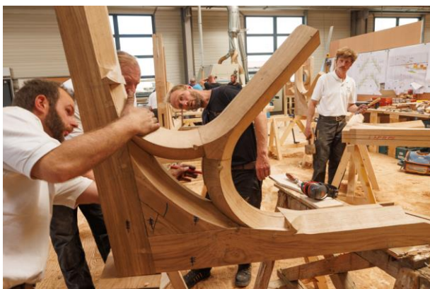
Visuel 7 : Des charpentiers vérifient les assemblages d'un des panneaux décorés des gradins. © Patrick Zachmann – Magnum Photos
