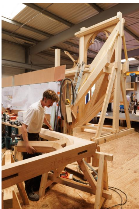
Visuel 5 : Un apprenti positionne un panneau de gradin pour en finaliser les moulures à la main, à l'aide d'un ciseau à bois. © Patrick Zachmann – Magnum Photos
