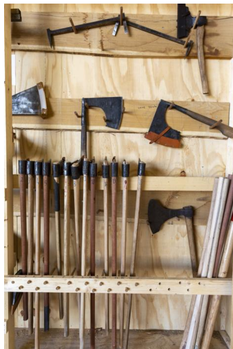
Visuel 12 : Haches et doloires utilisées pour la taille de la charpente du chœur. David Bordes © Rebâtir Notre-Dame de Paris.
