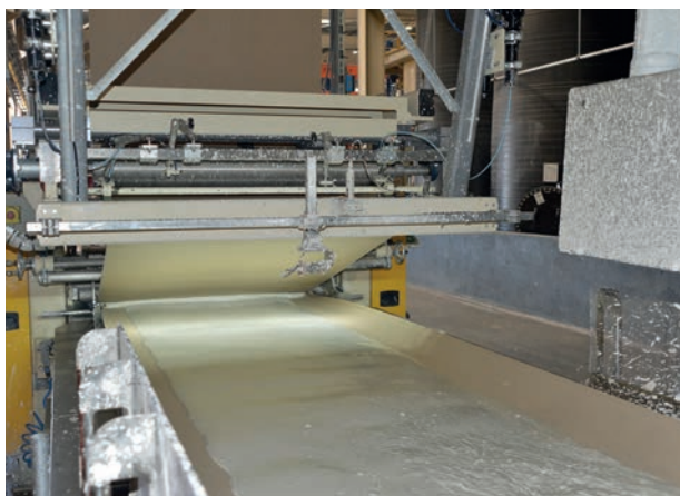
3. Coulée de gâchée entre 2 feuilles de carton
