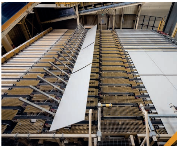
4. Retourneur en fin de ligne de production
