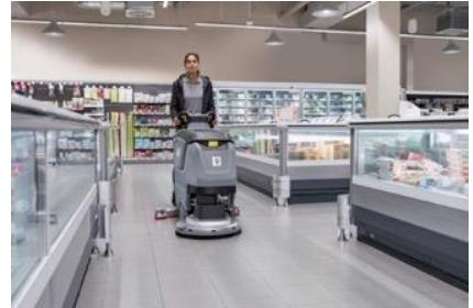
Sa tête de brossage et son suceur d'aspiration parabolique en aluminium assure un nettoyage et une aspiration de qualité, même dans les virages.
