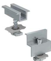
**Bride de serrage préassemblée PM** : pour les panneaux avec cadre aluminium de 28 à 54 mm d'épaisseur, équipée d'une platine écrou avec une protection en plastique spéciale pour faciliter le positionnement de la platine écrou dans le rail.
