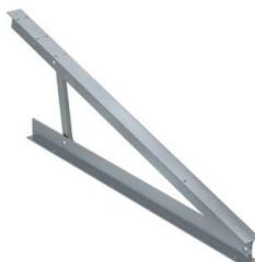
**Triangulation STFS 10°-13°** : pour les installations au format paysage, particulièrement adaptée pour minimiser l'impact visuel du système (conception abaissée à seulement 30 cm de hauteur) et l'action du vent dans le cas de toitures avec une maçonnerie périphérique de hauteur limitée. Angle réglable 10°-13°.
