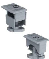
**Brides universelles préassemblées réglables PM U et PMC U** : pour les panneaux avec cadre aluminium d'une épaisseur de 30 à 50 mm, s'insèrent rapidement à l'intérieur des rails par simple rotation à 45°.
