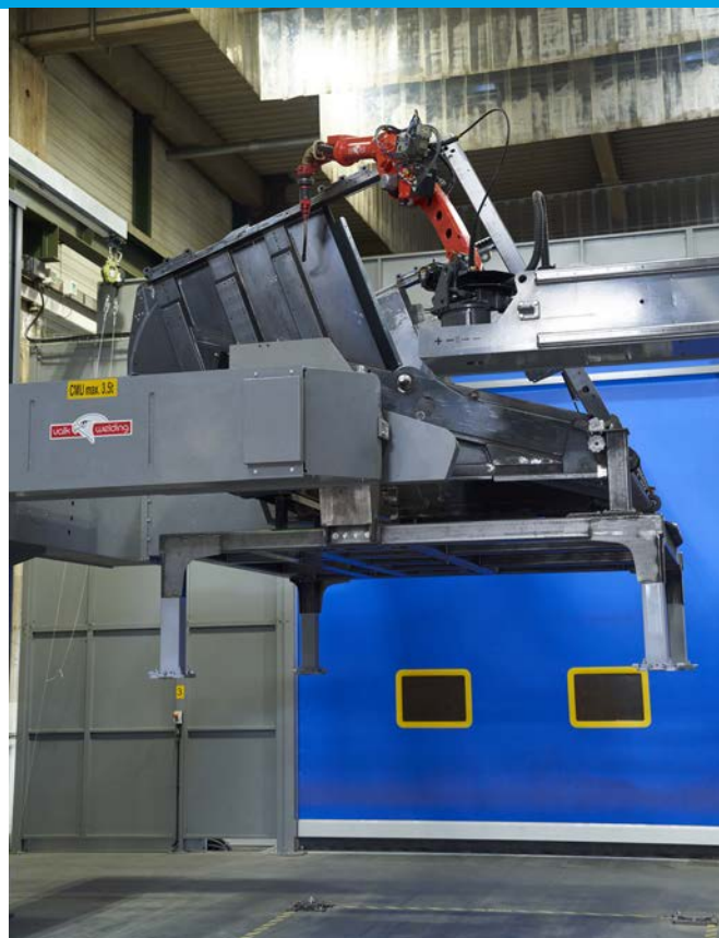
Un des deux robots de soudure de la ligne de fabrication des portes de bennes FAUN.
