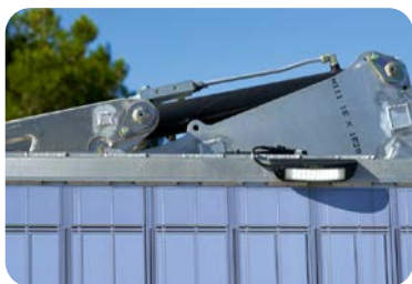
Caisson lisse double peau alvéolée en alliage d'aluminium
