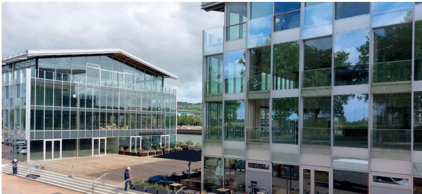
Hangar 105 | Rouen (76) : 250 m<sup>2</sup> de panneaux Nuancéa de type shadow box et 190 m<sup>2</sup> de panneaux de façade Glacéa en glace émaillée trempée viennent habiller les façades extérieures et les patios intérieurs.
