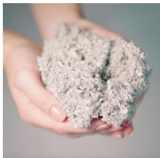
De plus, la densité et la structure de la ouate de cellulose entraînent une meilleure résistance à l'écoulement de l'air, ce qui préserve l'efficacité de l'isolant dans des conditions défavorables. L'isolation en ouate de cellulose a donc un réel impact pour **réduire les consommations d'énergie et faire baisser la facture de manière durable.**
