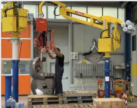
Utilisant uniquement l'air comprimé comme énergie et bénéficiant d'un grand rayon d'action, ce manipulateur pneumatique à bras articulé, de type PARTNER EQUO sur colonne permet d'effectuer la prise, la manutention et la dépose de composants pour opérer l'assemblage au final de grosses vannes hydrauliques, et ce, en toute aisance et sans aucun risque pour l'opérateur.
