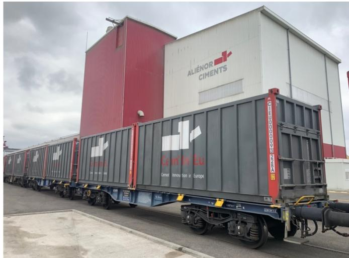
Le développement spécifique mené par VTG pour Cem'In'Eu a exigé une année de tests avec notamment la mise en circulation d'un prototype qui a permis d'affiner les réglages et de bien valider le rayon de courbure compatible avec la circulation sur les voies françaises. Une fois cette phase de test terminée, le changement des wagons a été organisé par Cem'In'Log en une seule opération entre deux livraisons sans aucune rupture des approvisionnements.
