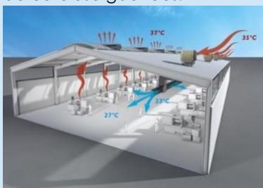
Ces filtres vont être constamment humidifiés par une pompe à eau et un réseau de distribution d'eau qui vont permettre une humidification totale de chacune des faces filtrantes du rafraîchisseur. Ensuite, un moteur de ventilation et sa pâle vont permettre d'aspirer l'air extérieur au travers des médias, charger l'air en humidité pour ensuite l'introduire à l'intérieur du bâtiment traité.
