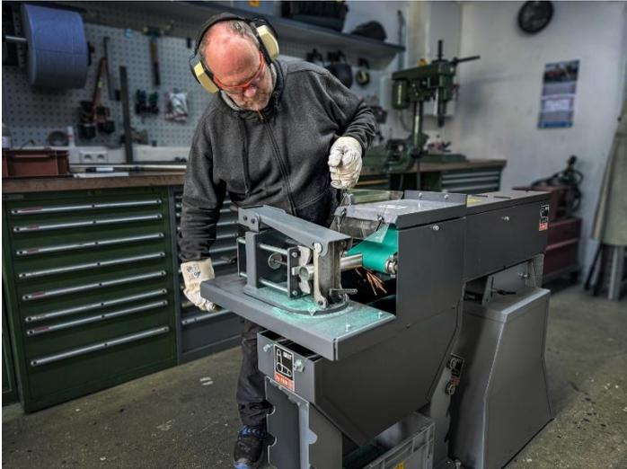
Légende : Ponçage précis d'arrondis de tubes et de profilés avec un diamètre de 20 à 193,7 mm.
