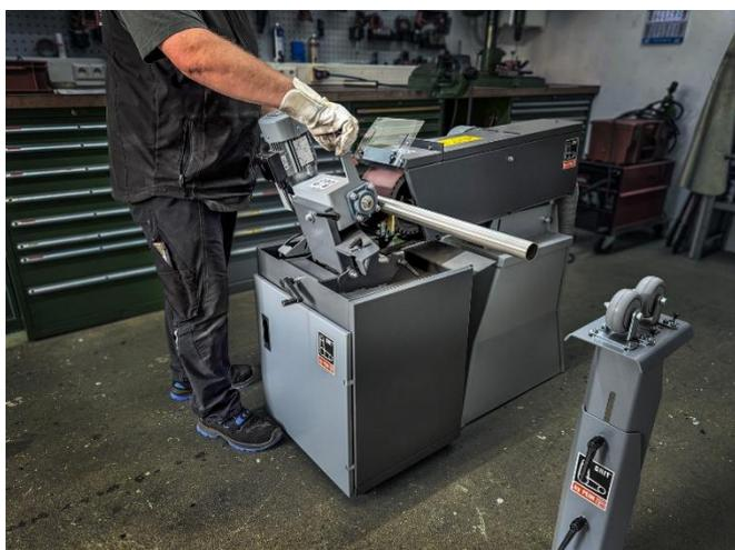
Légende : Ponçage de tubes d'un diamètre compris entre 10 et 130 mm avec le module GIC.
