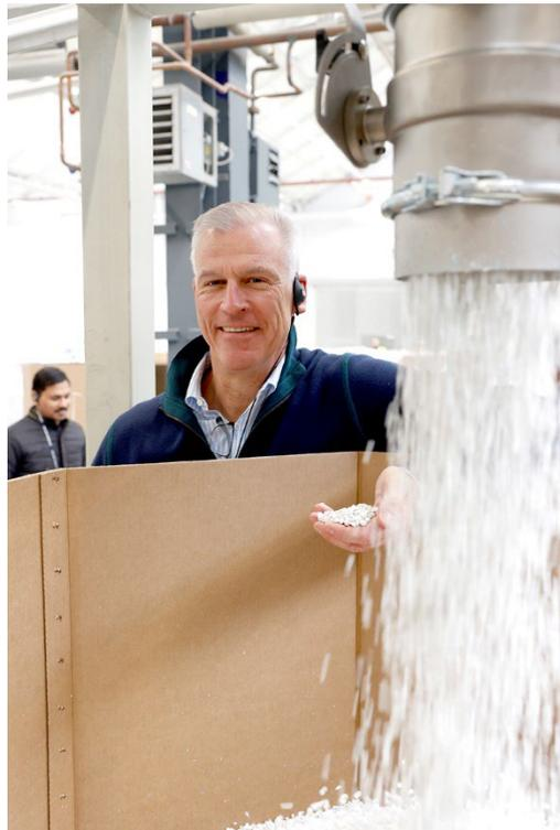
*Légende : Ces granulés recyclés premium sont réintégrés dans les profilés de fenêtres avec de la matière vierge.*
