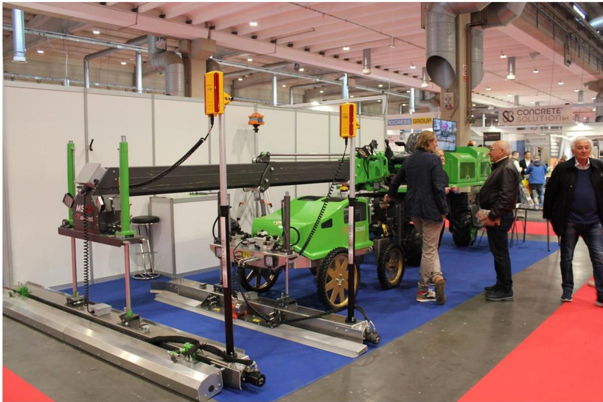
PET a présenté une nouvelle gamme d'équipements sur batterie INNOXAT, avec notamment une talocheuse (modèle 5015-000) et une aplanisseuse (modèle 5010-00). Autrefois disponibles uniquement en version câblée ou thermique, ces outils sont désormais bien plus pratiques, durables et confortables pour les ouvriers chargés de la finition de vastes dalles en béton.
