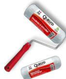
**Le rouleau à encoller et son manchon de recharge** – La fibre 12mm de ce rouleau en polyester ne peluche pas et offre une excellente prise de matière, pour une dépose régulière et optimale de n'importe quelle colle. C'est également un outil adapté pour l'application du primaire ou de la sous couche.
