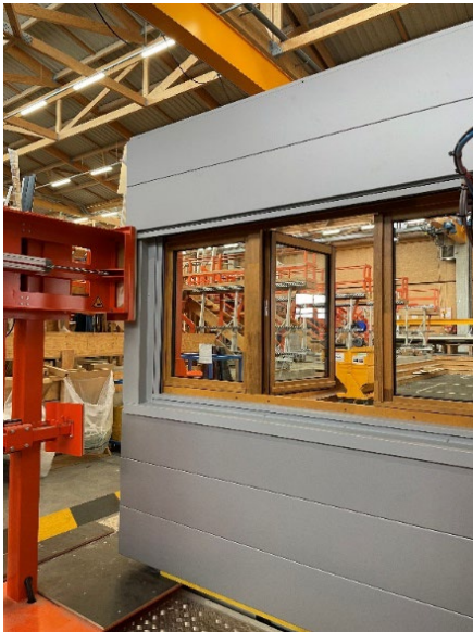
Préfabrication des panneaux de façades de Thiais à l'usine Sybois
