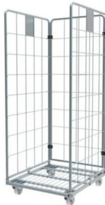
Ces trois modèles de rolls sont équipés de ridelles à grandes mailles afin de pouvoir y ranger des objets encombrants. Les roues sont en polyamide de 160 mm de diamètre, deux sont pivotantes et les deux autres sont fixes avec freins.
