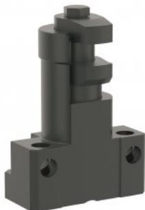
Les mors de serrage des brides de serrage flottantes offrent un point d'appui et de bridage supplémentaires aux points d'isostatisme traditionnels, c'est pourquoi ces brides de serrage flottantes sont particulièrement adaptée aux pièces brutes ou de formes complexes ou irrégulières. Elles empêchent également les vibrations pendant l'usinage, ce qui les rend idéales pour les pièces de faible épaisseur, sensibles aux déformations.
