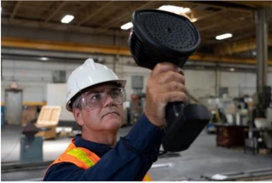
La nouvelle caméra permet d'effectuer des relevés jusqu'à 100 mètres, ce qui résout le problème des zones inaccessibles. À courte distance, sa sensibilité améliorée se révèle vraiment utile ; avec une plage de fonctionnement de 2 kHz à 65 kHz, la caméra est à même, grâce à cette sensibilité élevée, de détecter les fuites les plus infimes.
