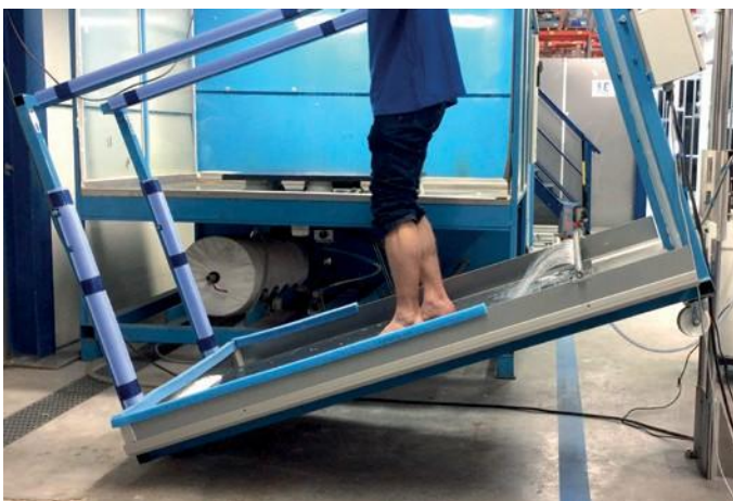
Ici le test de glissance des receveurs Kinedo.
