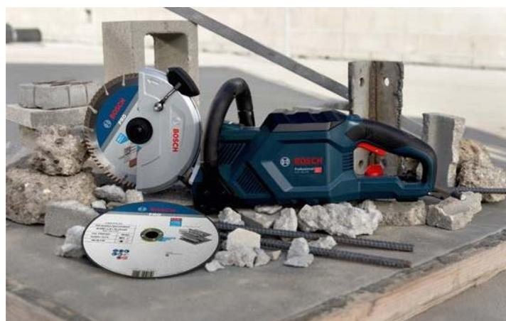
La GCS 18V-230 Professional possède un levier de verrouillage de la broche breveté qui bloque celle-ci rapidement et permet un changement facile du disque. **Pour une grande sécurité d'utilisation, le frein immobilise rapidement le disque dès que la gâchette est relâchée.**
